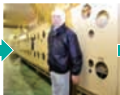
長さ18メートルのオーブンで3段階に分けて焼き上げます
