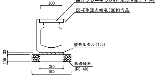
函渠型側溝工(300型) (点検孔) (横断部)
