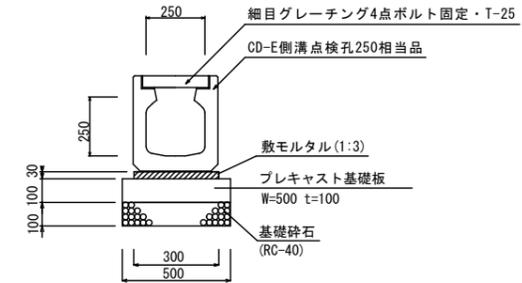
函渠型側溝工(300型) (縦断用)
