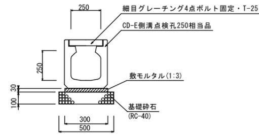
函渠型側溝工(250型) (点検孔) (横断部)
