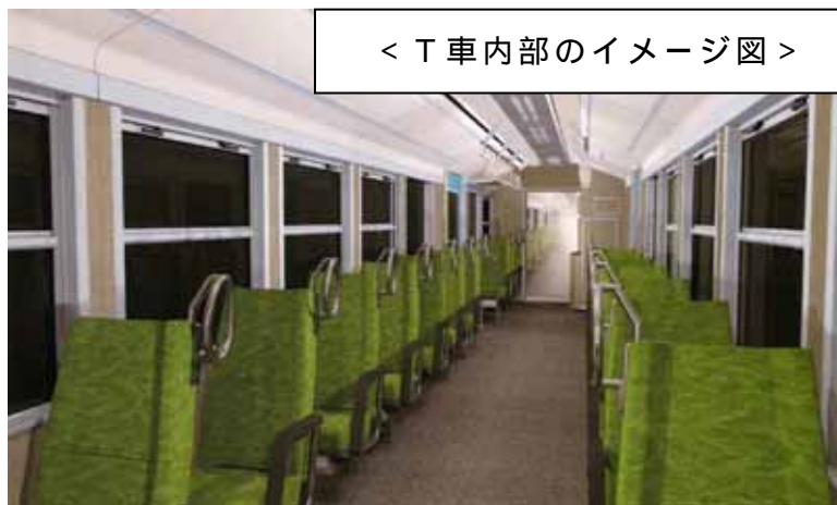
T車：電動機や運転室が付いていない車両（＝付随車）
