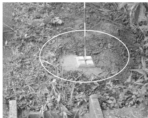
境界を確定した際に設置する境界杭の一例
