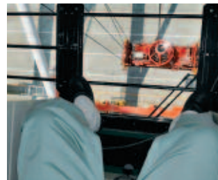
吊り具が揺れないように、操縦席を細かく前後に動かして制御します
