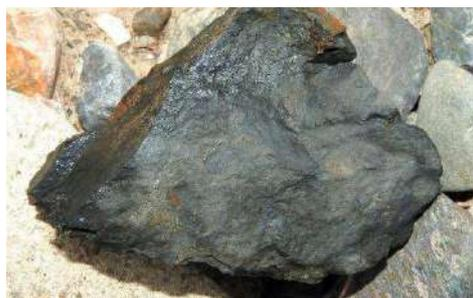
粘板岩は泥質堆積岩が圧力を受けて弱い変成作用を受けたもの。割れ方は特有の曲面になる。
