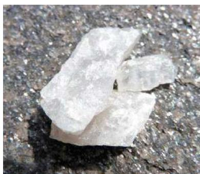
高温石英の成分は水晶と同じSiO<sub>2</sub>で、氷砂糖のような半透明。水晶谷で見つかる。ガラスは主に石英からできている。
