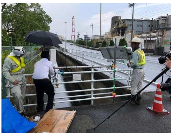
ごみの流入を確認するカメラの設置（天白川支流）
