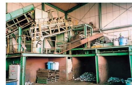
Awtomatikong tagabukod Ang magnet ay ginagamit upang pagbukod-bukurin at malaman kung ito ba ay bakal na lata o aluminyo na mga lata.
