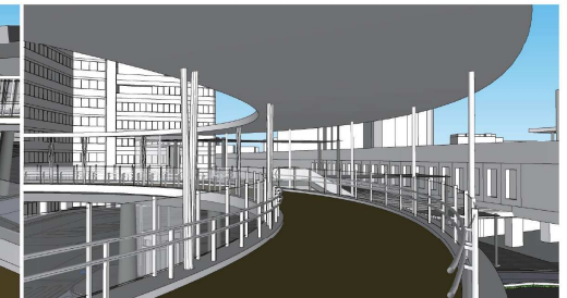
↑ 屋根が全幅に架かる西側は柱を両側に設けて屋根を支え、柱のピッチや配置の変化が歩く楽しさを演出
