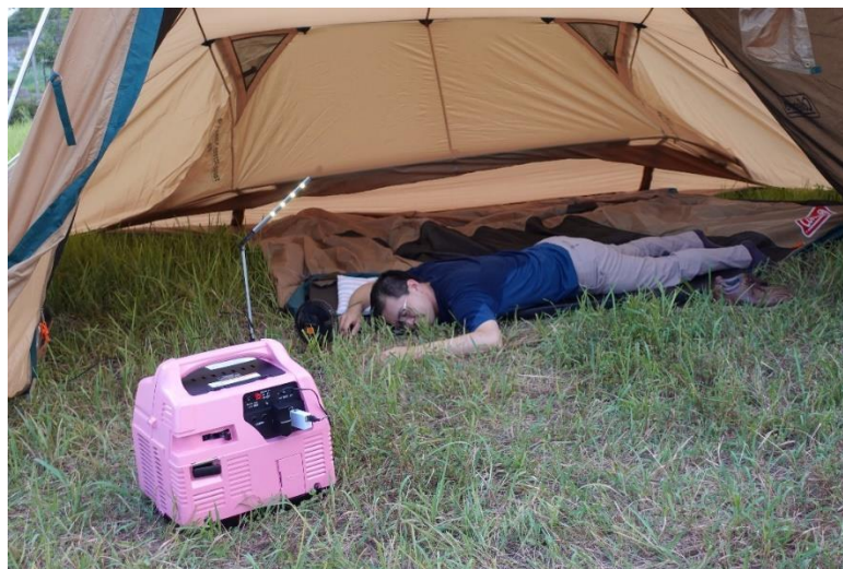
図1 一酸化炭素中毒事故のイメージ (テント入口で携帯発電機を使用)
