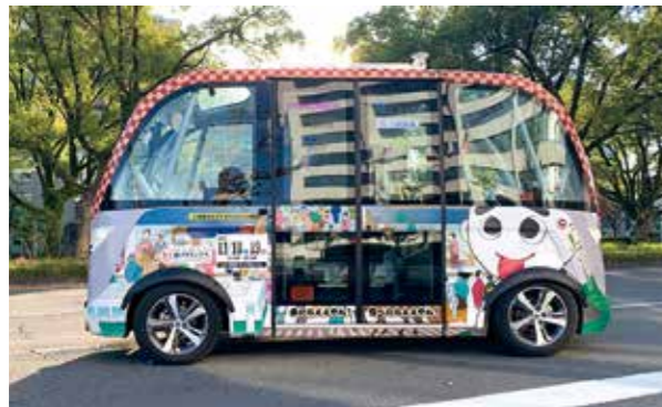
自動運転バス (ARMA) ハンドル、アクセル・ブレーキペダルがなく、自動で動きます
