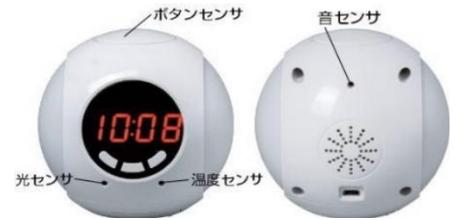
「音センサ」「光センサ」「温度センサ」「ボタンセンサ」の4種類のセンサを搭載
