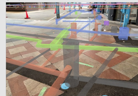
【仮想掘削穴による地下埋設物3DモデルのAR表示】
