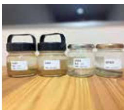
UFBと水道水を比較し、サビが 抑制されていることを確認
