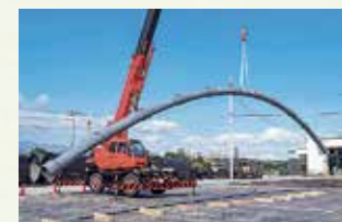
ダクタイル鋳鉄管は曲がっても抜けないため、地震に強い
